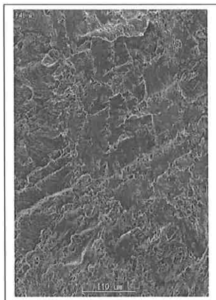
Figura 4 - Superfície de fratura resultante da propagação estável da trinca de fadiga.
