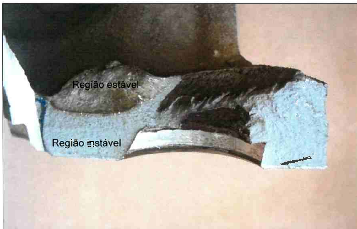
Figura 1 – Falha por fadiga do cabeçote próximo á face de fogo, observam-se duas trincas nucleadas na câmara de água que avançaram para o duto de escapamento.
