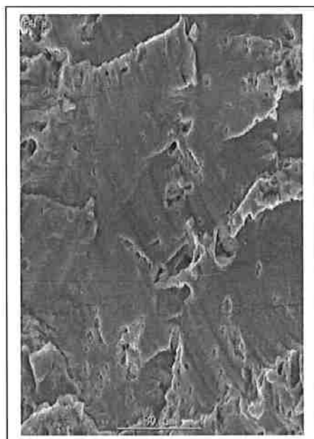
Figura 5 - Superfície de fratura resultante da propagação estável da trinca de fadiga.
